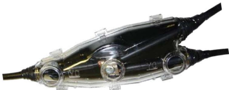
Utilisation universelle pour dériver les câbles à isolant synthétique basse tension ou conducteurs à isolant PVC, PE, VPE et EPR (par ex.: N(A)YY, NYM, TT) avec ou sans conducteurs concentriques. Utilisation appropriée pour câbles en cuivre et aluminium.
